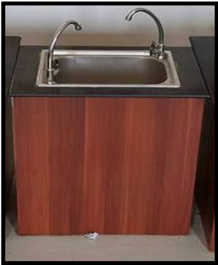
រូបភាព ៣.១៤- តុមានឡាបូលាងប្រើរួមគ្នា៖ តុមានឡាបូលាងរួមដែលមានក្បាលរូបិណ្ឌពីរជួយកាត់បន្ថយតម្លៃនៃបន្ទប់ពិសោធន៍វិទ្យាសាស្ត្រ ដែលបានបំពាក់ដោយឡាបូលាងស្ថិតនៅកណ្តាល បម្រុងសម្រាប់សិស្សពីក្រុមដែលមួយក្រុម ៦ នាក់ ប្រើក្នុងពេលតែមួយ។ ឡាបូលាងទៀតសោតត្រូវធ្វើពីលោហៈធាតុដែលមានគុណភាពខ្ពស់ ដើម្បីជៀសវាងពី ច្រោះ ឬ ធ្វើពីសេរ៉ាមិចដែលធន់នឹងការឆ្លុត។ តុក៏ត្រូវធ្វើពីថ្មម៉ាបនៅផ្ទៃខាងលើដើម្បីការពារទឹកជ្រាបចូលក្នុងគ្រោងក្តារហ្វូមេការខាងក្រោម។ ដោយសារតែបំពង់ទុយោបង្ហូរទឹកនៅកម្រាលខាងក្រោមបានភ្ជាប់ជាមួយឡាបូលាង ដូច្នោះតុមានឡាបូមិនត្រូវធ្វើឲ្យរំកិលបាននោះទេ។ ដោយហេតុផលនេះ ក្រុមការងារលទ្ធកម្មអាចជ្រើសរើសការប្រើប្រាស់ទាំងពីរបាន ដោយគុគ្រោងឈើបិតហ្វូមេកា (ដូចបានបង្ហាញក្នុងរូបភាពខាងឆ្វេង) គឺជាជម្រើសមានតម្លៃថោក ឬក៏ការចាក់ស៊ីម៉ង់ត៍ជាមួយការបិទសន្លឹកហ្វូមេការដែលប្រើពណ៌ដូចគ្នា។ ជម្រើសចុងក្រោយនេះមានតម្លៃថ្លៃជាង ប៉ុន្តែជឿជាក់ថាបានបន្ថែមនូវកម្រិតនៃការការពារការខូចខាតដែលបណ្តាលមកពីទឹកជ្រាបចូលពីឡាបូលាង។
